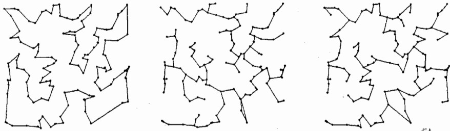
図 2. ch130 都市 (最適巡回路, 初期最小一木, ラグランジュ後最小一木)
